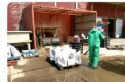
Phase 2. Rinçage sous pression
