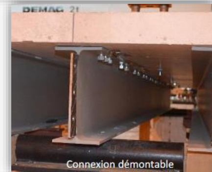
Collaboration mécanique des 3 matériaux
